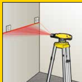
◀ Nivelación y alineación horizontal y vertical
